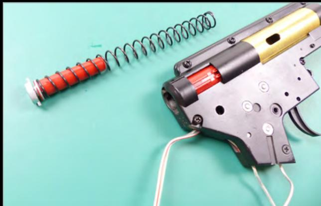
La gearbox est équipée d'un système quick change, ce qui évite de l'ouvrir pour changer le ressort.
