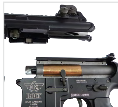
En dehors du système de recul, la B4 se démonte comme un AEG classique.
