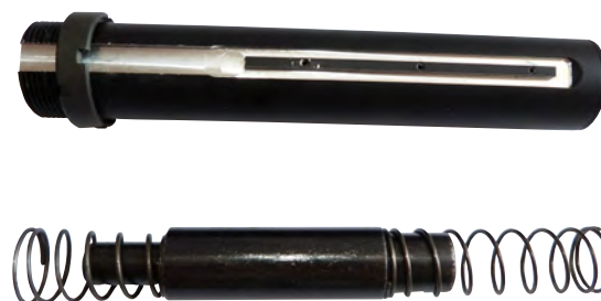
Les pièces qui génèrent le recul, ou Bolt Recoil Shock System (BRSS).
